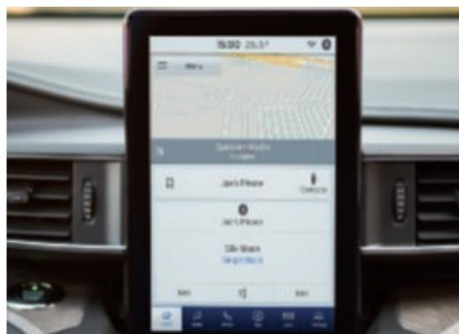
Touch screen LCD TFT 10,1" con orientamento verticale.
